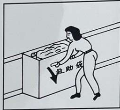
② キャビネットの 前板を取り除き Remove cabinet front cover.
