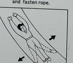
⑥ 足を拡げて スピードを調節する Open legs to control speed.
